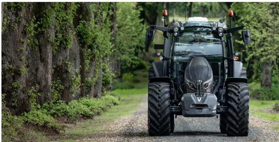
La série G est désormais équipée d'une nouvelle transmission à variation continue. Les modèles Powershift et la puissance de tous les modèles restent inchangés. Le capot, l'accès facile à la cabine et l'excellente visibilité sont identiques, mais les nouveaux garde-boue arrière sont plus couvrants et les commandes du relevage, de la prise de force et de la barre supérieure situées à l'arrière sont désormais placées de manière plus conviviale.
