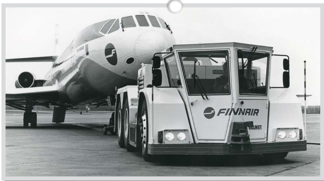
La cabine pouvait être surélevée de 0,5 mètre afin d'améliorer la visibilité en marche arrière
