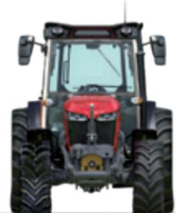
Ab einer Breite von 1,70 m und mit einer breiteren Vorder- und Hinterachse eignet sich das Modell für den Wein- und Obstbau in Hanglage. Der MF 3WF leistet 75 bis 120 PS mit Kabine und ist auch in einer Plattformversion mit bis 105 PS erhältlich.
