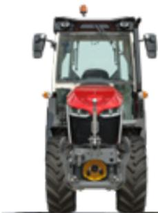
Der MF 3VI ist dank seiner geringen Breite ab 1,00 m ideal für Arbeiten in Weinbergen mit schmalen Abständen zwischen den Zeilen. Das Modell ist nur mit Kabine erhältlich und verfügt über 75 bis 120 PS.
