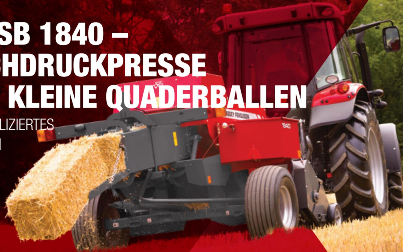
Die MF SB 1840 eignet sich ideal für Großbetriebe, die eine optimale Produktivität anstreben, sowie für Familienbetriebe oder kleine Reitställe. Die wohlgeformten, hochwertigen Rechteckballen (46 cm breit, 36 cm hoch und bis zu 1,3 m lang) haben die richtige Dichte für Handhabung, Fütterung und Transport.
