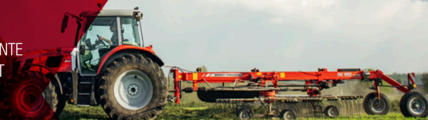
Von Einkreiselmodellen mit einer Arbeitsbreite von 3,40 m bis zu Vierkreiselversionen mit einer Breite von 13,80 m – Massey Ferguson bietet eine umfangreiche Palette an Schwadern mit seitlicher oder mittiger Ablage passend zu Ihren Anforderungen.
