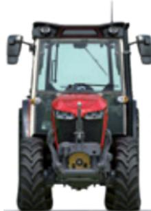
Mit einer Breite ab 1,25 m ist der MF 3SP auf Weinberge mit breiteren Zeilen ausgelegt. Das Modell besitzt eine geräumige Kabine und ist mit einer Leistung von 75 bis 120 PS erhältlich.
