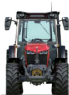
Mit einer Breite ab 1,45 m eignet sich der MF 3FR ideal für weit auseinanderliegende Rebzeilen und Obstplantagen. Ein gut ausgestatteter Traktor mit breiterer Vorderachse und geräumiger Kabine, erhältlich von 75 bis 120 PS sowie in einer Plattformversion mit bis zu 105 PS.
