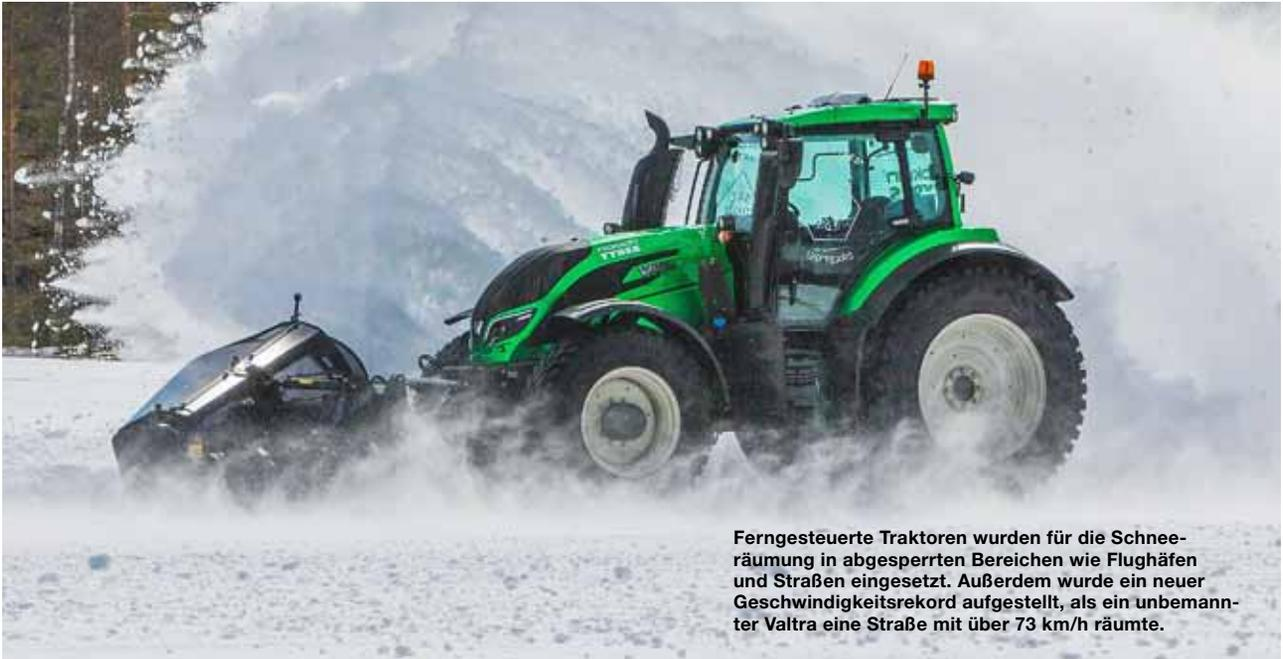
Ferngesteuerte Traktoren wurden für die Schneeräumung in abgesperrten Bereichen wie Flughäfen und Straßen eingesetzt. Außerdem wurde ein neuer Geschwindigkeitsrekord aufgestellt, als ein unbemannter Valtra eine Straße mit über 73 km/h räumte.
