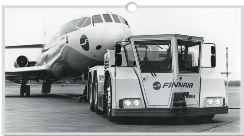
Der Flugzeug-Pushback-Traktor Valmet 1542, hier beim Bewegen einer Super Caravelle der Finnair.
