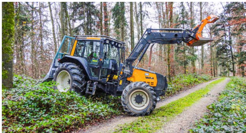
Dank der Knicklenkung ist der Valtra X110 wendig im Forst unterwegs.
