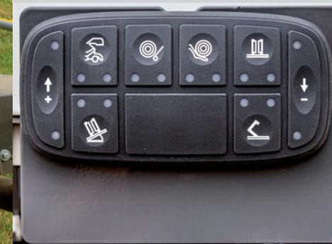
Ein externes Bedienpult im hinteren Bereich der Ballenpresse ermöglicht die Steuerung der Heckklappe, des Wickelrings, des Tisches und der Folienhalter – für einen schnellen Rollenwechsel sowie einfache Wartung und Reinigung.
