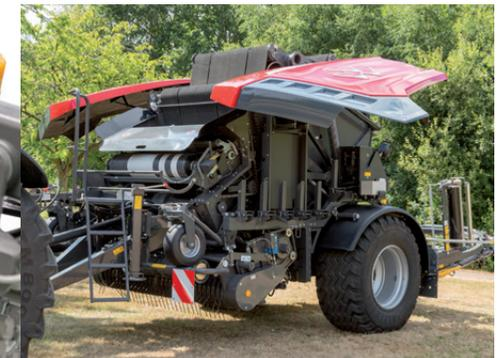
An beiden Seiten der Ballenpresse befinden sich in bequemer Höhe zwölf Folienrollenhalter und mit zwei zusätzlichen, am Wickler installierten Rollen wird die Effektivität auf dem Feld weiter gesteigert.
