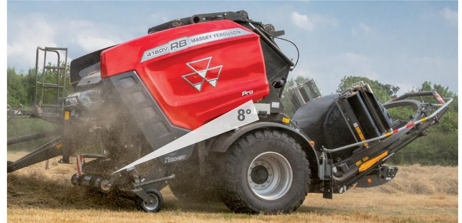
Die neue Protec-Kombination weist einen flacheren Winkel des Gutflusses auf, was zu einer niedrigeren Gesamthöhe der Presse führt. Dies steigert die Fahrstabilität und ermöglicht somit einen sichereren und schnelleren Einsatz an Hängen. Darüber hinaus wird auch der Gegendruck im Zuführbereich reduziert, was den Materialfluss optimiert und das Risiko einer Blockade minimiert.
