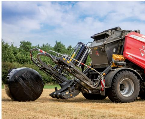
Für einen sanften Ballenauswurf neigt sich der Wickeltisch weit zum Boden hin. Dies minimiert die Rotationsgeschwindigkeit des Ballens und verhindert somit eine Beschädigung der Folie, während zugleich die ideale Ballenform aufrechterhalten wird. Ein optionaler Ballenkipper verhindert ein Wegrollen der Ballen und erleichtert das Beladen des Anhängers. Der Fahrer kann zudem zwischen einem automatischen und einem manuellen Entlademodus wählen.
