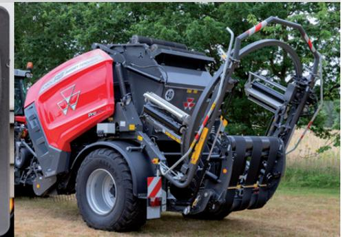
Die Wickeleinheit kann hochgeklappt werden, um einen sicheren und komfortablen Transport von Feld zu Feld zu ermöglichen.
