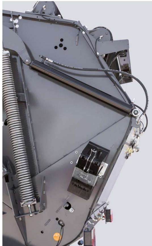
Das Volumen des Ballens steigt exponentiell zu dessen Durchmesser. So steigt auch die Riemenspannung kontinuierlich an, um für eine konstante Ballendichte zu sorgen.
