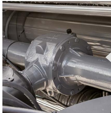
Das Powersplit-Getriebe teilt die Leistung gleichmäßig auf und überträgt sie entsprechend, um einerseits den Einzugsrotor und andererseits die Wellenantriebe anzutreiben, wodurch der Energieverbrauch gesenkt wird. Das Ergebnis ist eine effizientere Ballenpresse, die einen geringeren Kraftstoffverbrauch aufweist.
