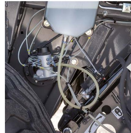
Die automatische Kettenschmierung ermöglicht eine individuelle Anpassung für jede Kette und gewährleistet stets eine optimale Ölzufuhr, wodurch die Wartungszeit verringert und die Lebensdauer der Ketten verlängert wird. Zur weiteren Optimierung der Langlebigkeit werden bei den Ballenpressen stets Ketten von höchster Qualität verwendet.
