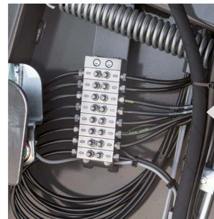
Eine regelmäßige und ausreichende Schmierung der Walzenlager ist überaus wichtig, insbesondere bei schwierigen Bedingungen, d. h. zum Beispiel beim Pressen von Silage. Zentrale Wartungspunkte zur Schmierung der Wellenlager sind an gut zugänglichen Stellen positioniert und ermöglichen somit eine einfache und schnelle Wartung.
