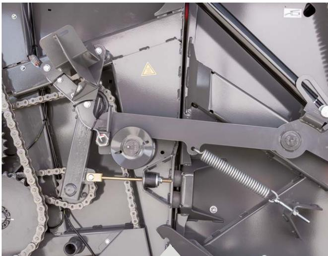
Die mechanische Heckklappenverriegelung funktioniert einfach, schnell und zuverlässig und sorgt so für einen einheitlichen Ballendurchmesser, eine höhere Ballendichte und einen geringeren Energieverbrauch.
