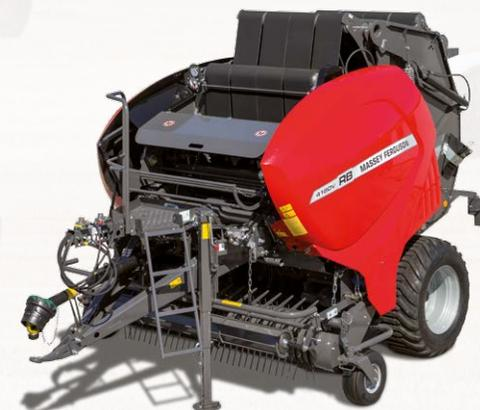
Die Modelle RB 4160V und RB 4180V von Massey Ferguson verfügen über eine einheitliche Plattform und formen Ballen mit einem Durchmesser von 0,9 m bis 1,60 bzw. 1,80 m.
