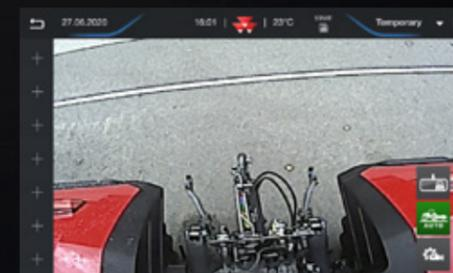
**Video-Modus** – Bilder einer Rückfahrkamera können auf dem Bildschirm dargestellt werden. Diese kann der Fahrer nutzen, um den Einsatz komplexer Arbeitsgeräte zu überwachen oder um die Sicherheit und Schnelligkeit beim Rückwärtsfahren zu erhöhen.
