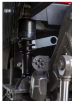
Die **AKTIVE MECHANISCHE KABINENFEDERUNG** verwendet Silentblock-Buchsen und federgestützte Stoßdämpfer für eine optimale Dämpfung in allen Fahrsituationen. Der Dämpfungsgrad kann vom Fahrer nach Bedarf eingestellt werden.
