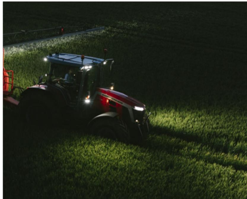
Die **OPTIONALEN 16 LED-LEUCHTEN** machen die Nacht zum Tag. Zu den Vorteilen zählen die automatische Aktivierung der Rundumleuchte und ein Verzögerungsschalter zum automatischen Abschalten der Arbeitsscheinwerfer nach Arbeitsschluss.
