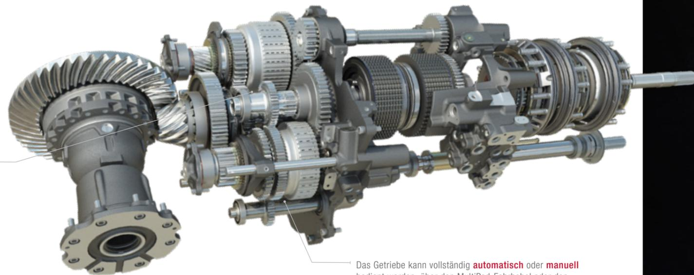
Das Getriebe kann vollständig **automatisch** oder **manuell** bedient werden, über den MultiPad-Fahrhebel oder den PowerControl-Hebel. Darüber hinaus kann je nach Aufgabe und Arbeitsbedingung festgelegt werden, wie aggressiv und schnell die vollautomatischen Gruppenwechsel erfolgen.
