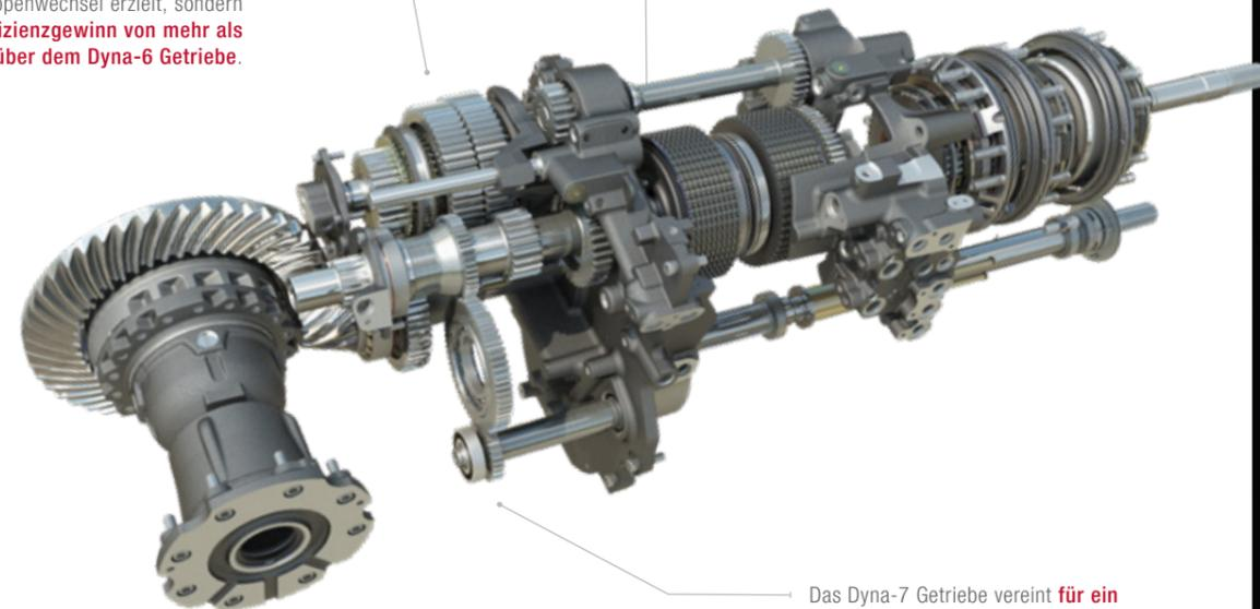
Das Dyna-7 Getriebe vereint für ein **außergewöhnliches Fahrerlebnis komfortable Bedienung** mit höchster Wirtschaftlichkeit. Das einzigartige Dyna-7 Getriebe bietet in allen vier Gruppen eine sanfte 7-Stufen-Dynashift-Schaltung, sodass für maximale Produktivität im Feld eine enorme Lastschalt-Flexibilität über einen großen Geschwindigkeitsbereich verfügbar ist. Dynashift- und Gruppenwechsel können dabei unter Last vorgenommen werden, ohne das Kupplungspedal zu betätigen.
