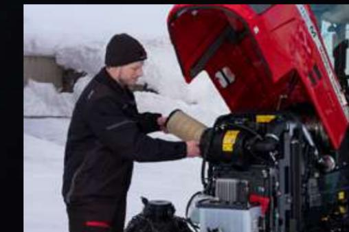
Die kompakte Kühleinheit ist bequem zugänglich, einfach zu reinigen und zu warten. Auch der Luftfilter des Motors ist bequem zugänglich und leicht zu reinigen.
