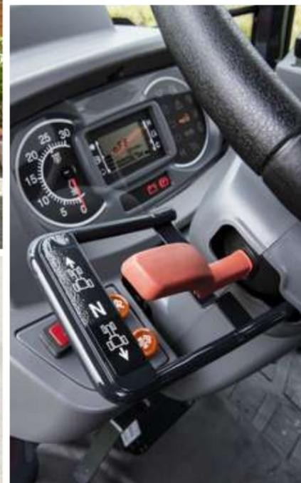
Für Modelle der Baureihe MF 1700 M: elektrohydraulischer Schalthebel für zusätzlichen Komfort
