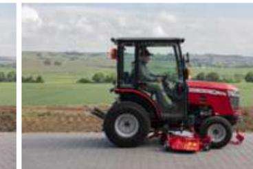
Das neue, verbesserte 152 cm breite Mähwerk ist mit drei Messern ausgestattet und bietet Schnitthöhen von 20 mm bis 115 mm, in acht Stufen. Die Höhe kann vom Fahrersitz aus eingestellt werden und erreicht eine Bodenfreiheit von 150 mm.
