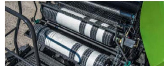
Le système EasyLoad permet de charger des rouleaux de rechange en un moins de temps qu'il ne faut pour le dire.
