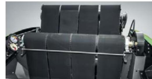
Les balles sont formées par quatre courroies sans fin disposées de manière symétrique. Le système d'entraînement est alimenté par deux rouleaux pour délivrer juste la force nécessaire.
