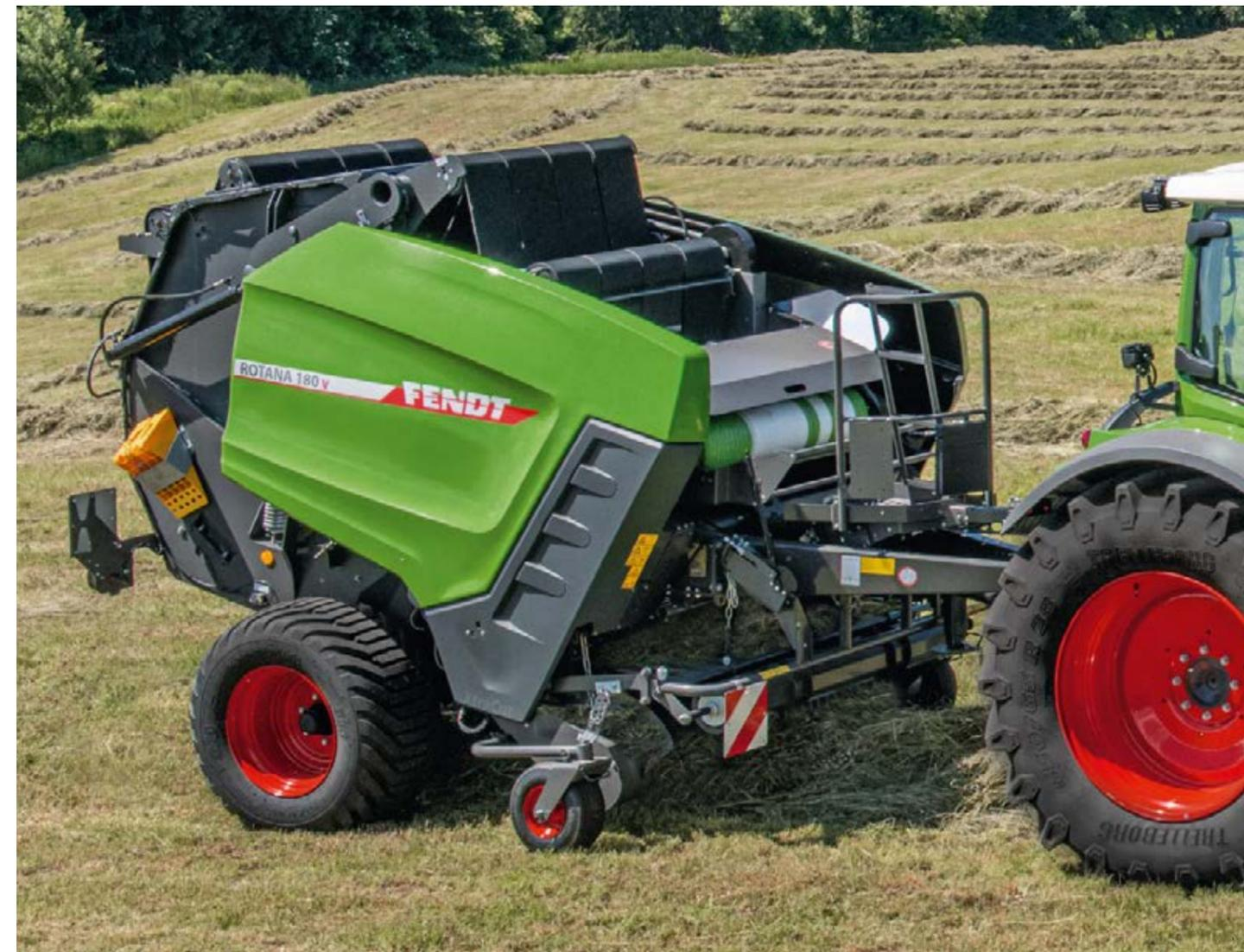
Le pick-up sans chemin de came se distingue autant par sa facilité d'entretien que son fonctionnement tout en souplesse. Les roues du pickup sont fixes ou pivotantes selon la configuration choisie.
