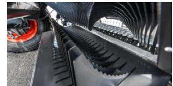
Les modèles Rotana 160VXtra et 180VXtra proposent un système de coupe avec sélection hydraulique groupée de 0, 12, 13 ou 25 couteaux
