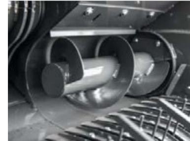
Autre dispositif standard des presses à chambre variable, le rouleau tasse andains garantit un flux de fourrage optimal.
