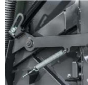
La rampe de déchargement de balle (qui peut être ajustée sans outils) donne à la balle l'élan souhaité et permet d'éviter toute collision avec la porte.
