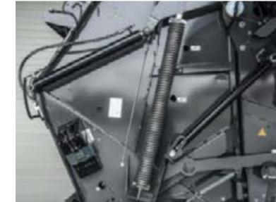
Grâce au dispositif de suspension de porte intelligent du bras balancier, la porte se déplace vers le bas à mesure que la balle grossit.
