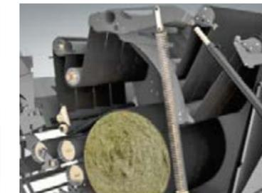
La courroie est entraînée par les deux rouleaux entraînés. L'entraînement double des rouleaux signifie une rotation parfaitement fiable, quel que soit le type de balle.
