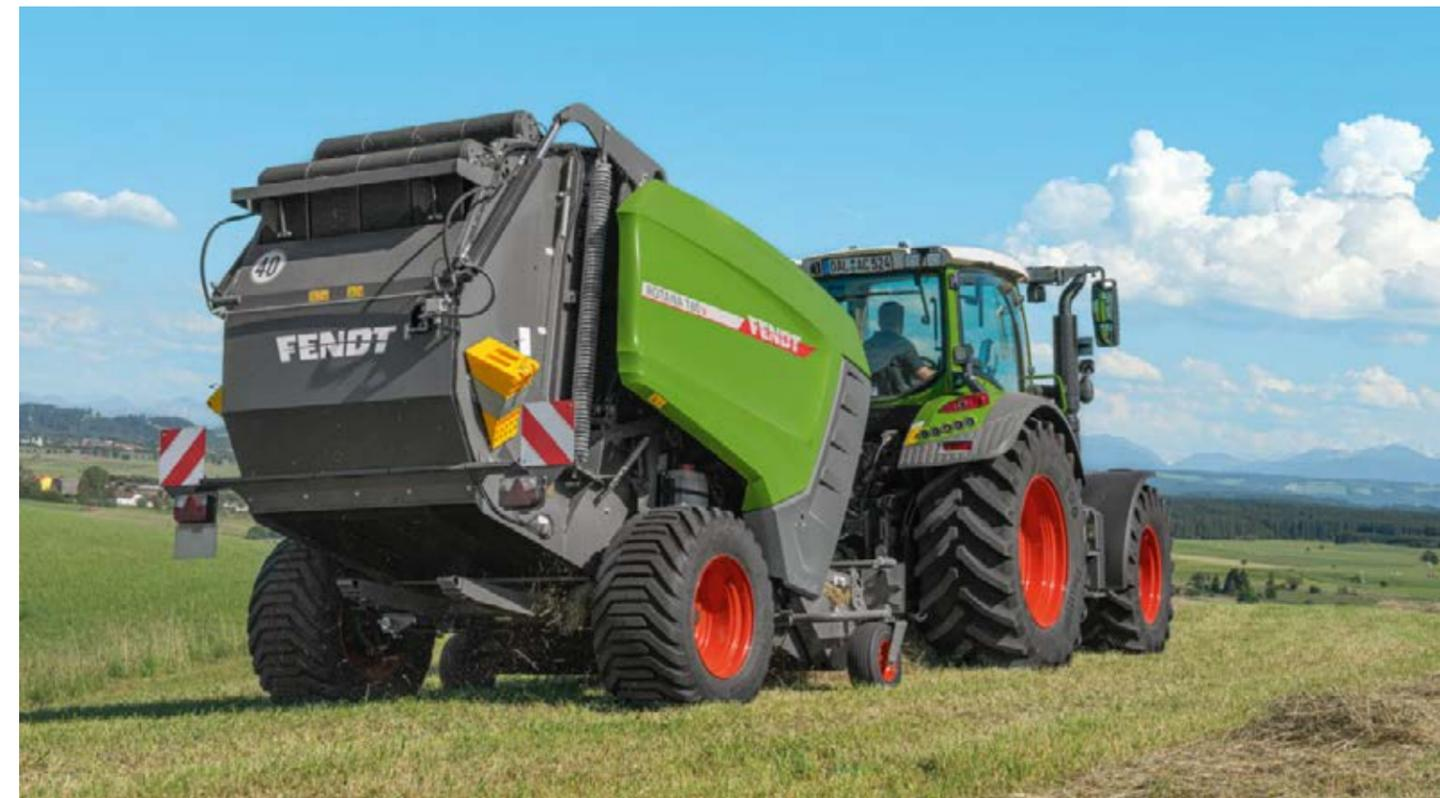
Grâce à leurs pneus larges, les presses à balles rondes à chambre variable Fendt constituent une solution fiable sur tous les terrains tout en protégeant la couche végétale.
