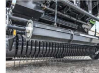
Grâce à la distance réduite entre le pick-up et le rotor, le fourrage est acheminé en souplesse et en toute sécurité. Grâce à sa forme en V, la chambre de pressage se remplit de façon homogène ce qui se traduit par des balles de qualité.
