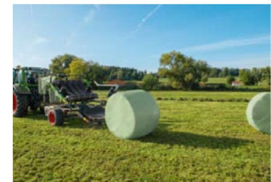
Le bras de chargement et la table d'enrubannage peuvent tous deux être adaptés à différentes tailles de balles. Ramassez en toute sécurité des balles de 1,25 m à 1,6 m de diamètre et enrubannez-les dans un film hermétique.
