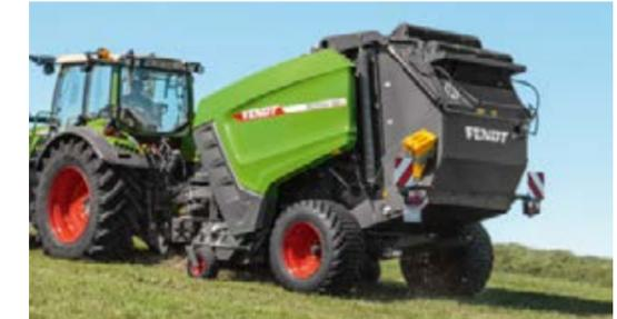
Les presses à balles rondes à chambre variable Fendt facilitent la compression des balles d'un diamètre de 0,70 à 1,60 m ou 1,80 m.
