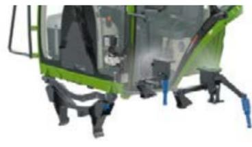
La suspension de cabine mécanique est dotée de deux plots coniques, et l'arrière de deux ensembles ressorts mécaniques.
