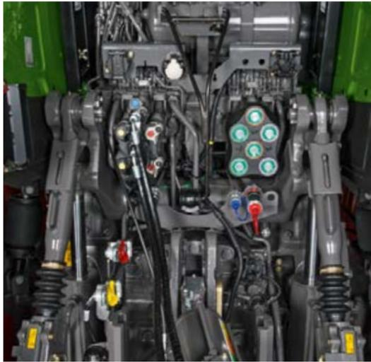
Le Fendt 1000 Vario peut aussi être personnalisé, à la demande, avec l'ajout ou la suppression d'options. L'arrière totalement équipé bénéficie de toutes les fonctionnalités et de tous les raccords nécessaires, notamment Power Beyond, prise ISOBUS, retour hydraulique, prise de force et relevage arrière.
