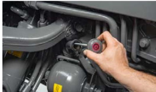
Les opérations d'entretien, par exemple, vérification du niveau d'huile ou changement du filtre, peuvent s'effectuer facilement et rapidement sur le Fendt 1000 Vario. Le compartiment moteur est d'un accès particulièrement facile grâce aux panneaux latéraux amovibles.
