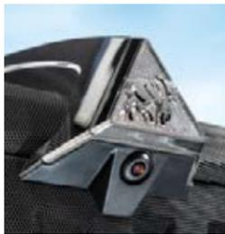
Un ajout très pratique pour les outils fixés à l'avant : la nouvelle caméra intégrée dans la calandre du capot donne une bonne visibilité sur les bras inférieurs grâce à l'affichage sur le terminal Vario.
