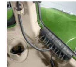
Le passe-câble intégré assure un guidage propre des câbles, lunette arrière fermée tout en assurant la protection contre la poussière, l'eau et le bruit. Plus de câbles qui s'emmêlent : tous les câbles sont fixés et guidés dans le montant arrière.
