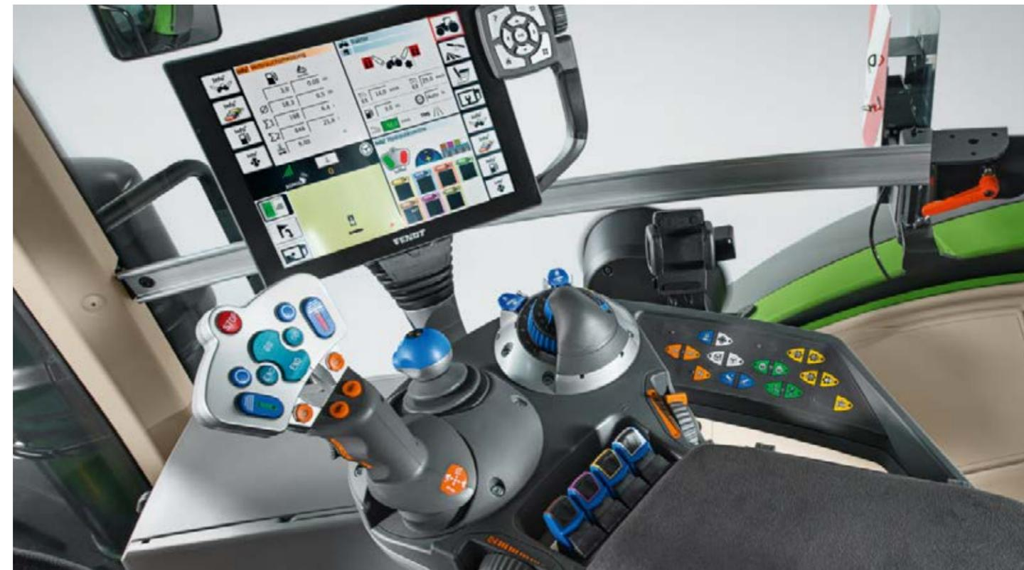
La conception ergonomique de l'accoudoir droit intègre le terminal VarioTronic 4 en 1, le joystick multifonction, le levier en croix, le module de relevage EHR, les commandes des distributeurs et le panneau de touches confort : c'est le centre de contrôle névralgique du conducteur, qui vous place au centre de toutes les commandes.
