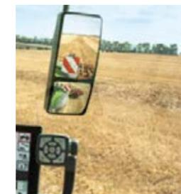
Les rétroviseurs grand-angle peuvent être librement déplacés pour étendre le champ de vision vers l'arrière.
