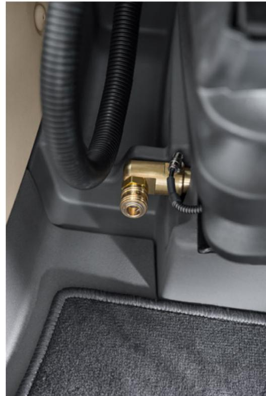
La cabine est aussi facile à nettoyer : le siège conducteur (siège Super Comfort Evolution) dispose d'un raccord pratique pour un tuyau d'air comprimé qui permet de nettoyer la cabine.
