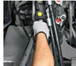
Les clapets des coupleurs hydrauliques à fermeture automatique assurent une excellente protection contre la pénétration de poussière tout en autorisant le branchement d'une seule main.
