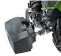
Le relevage avant est parfaitement intégré au tracteur.
