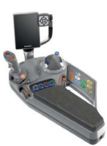
Accoudoir multifonction en configuration Power : Terminal Vario 7"; joystick Power avec commandes du séquençage de fourrière Variotronic<sup>®</sup>, des Tempomat et d'un régime moteur programmable ; module de commande du relevage arrière et prise de force ; terminal Vario 7" avec interface de smartphone et surface en verre pour une excellente vision de toutes les fonctions, guidage intuitif par menu, commandes tactiles et par touches, et commande de machine ISOBUS.
