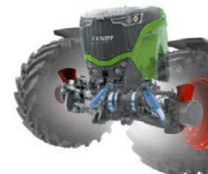
Essieu avant avec suspension indépendante, avec régulation de l'assiette et freinage sur chaque roue.
