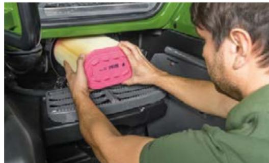
Le filtre de cabine est positionné de façon pratique à proximité de la porte et peut être nettoyé facilement si nécessaire.
