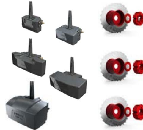
Le Fendt 1000 Vario est extrêmement modulable en matière de lestage. Plusieurs masses avant sont proposées de 870 kg jusqu'au maximum de 3 300 kg, ainsi que des masses de roues de 2 x 650 kg à 2 x 1 250 kg.
