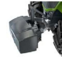
Le support d'attelage avant permet l'attelage rapide et simple d'une masse avant même sans relevage avant.
