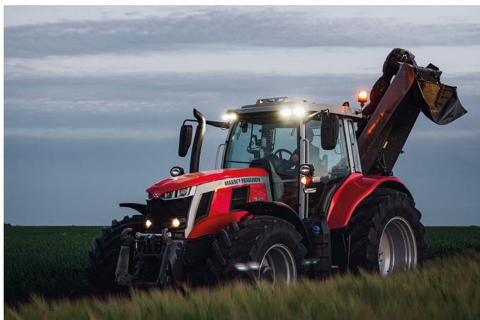
Ein neuer Automatikmodus sorgt für einen ruhigeren Betrieb. Er stellt automatisch die optimale Motordrehzahl je nach Last und Geschwindigkeit ein und lässt sich einfach über das Fußpedal oder den MultiPad-Fahrhebel bedienen.
