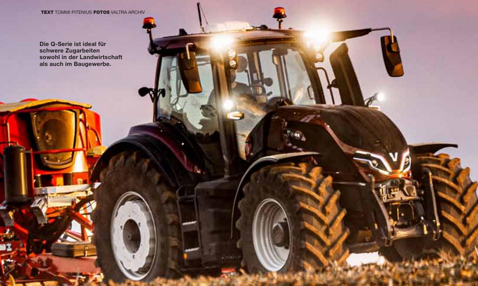
**„Die Abmessungen der Q-Serie sind überschaubar. Der Traktor ist relativ leicht, aber die maximale Zuladung ist hoch. Außerdem ist er für seine Größe sehr wendig. Der lange Radstand und der niedrige Schwerpunkt sorgen für Stabilität beim Fahren auf der Straße.“**
