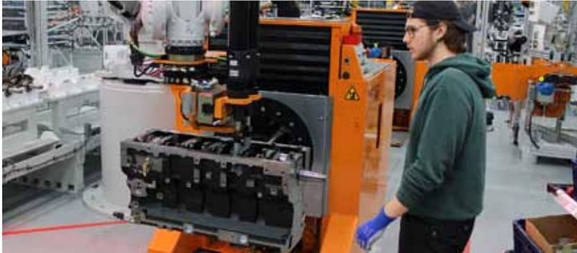
Mechaniker Julius Salmela baut eine Kurbelwelle mit Hilfe eines Industrieroboters ein.
