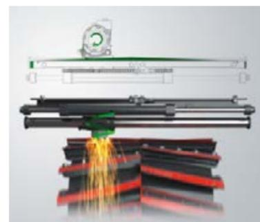
Mit 720 mm Durchmesser verfügt der Fendt Katana über die größte Messertrommel am Markt. Die V-förmig angeordneten Messer leisten mit bis zu 23.000 Schnitten/min. (40-Messertrommel) eine besonders hohe Schnittfrequenz.
