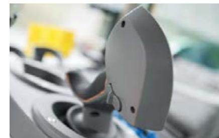
An der Rückseite des Multifunktionshebels lässt sich der Rollenniederhalter der PickUp per Wipptaster bedienen. Im Maiseinsatz lässt sich damit der Pendelrahmen manuell schwenken und im Straßenmodus der Blinker bequem betätigen.
