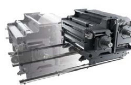
Der extrem effiziente R-Cracker mit Sägezahnprofil lässt keinem Korn eine Chance. Dank der gigantisch großen Aufbereitungsfläche zwischen den großen Walzen und einer Drehzahldifferenzen von 30 oder 40% zwischen den beiden Aufbereiterrollen liefert er überragenden Kornaufschluss.
