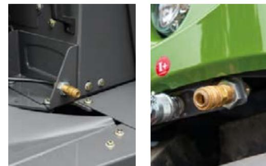
Drei integrierte Druckluftanschlüsse ermöglichen die Trockenreinigung wichtiger Fahrzeugteile direkt auf dem Feld.
