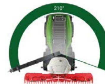
Auch bei einer Überladehöhe von über sechs Metern hat der Fahrer die Auswurfklappe voll im Blickfeld. Optional kann der Auswurfbogen verlängert werden, um auch bei breiten Vorsätzen das Abfuhrfahrzeug optimal zu befüllen.
