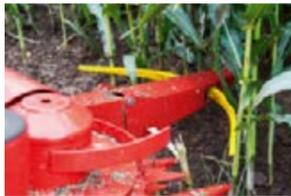
Durch die Reihentaster an den Spitzen des Maisvorsatzes arbeitet sich der Katana zentimetergenau und vollautomatisch durch den Bestand.
