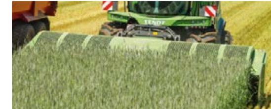
Das robuste Direktschneidwerk ist für tiefe, verlustfreie Schnitte unterschiedlichster Fruchtarten ausgelegt. Bei der Ernte von Biomasse liefert es beste Silagen mit minimalem Schmutzanteil.
