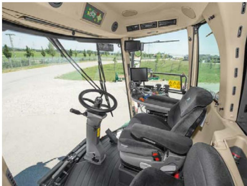
Die Visio5 Kabine ist auf optimale Sicht ausgelegt und bietet eine perfekte Ergonomie und Bedienung am Arbeitsplatz. Dank der speziell ausgeformten Dachkontur hat der Fahrer die Auswurfklappe bequem im Blick. Angenehmes Arbeitsklima gewährleisten Klimaautomatik und Heizung.
