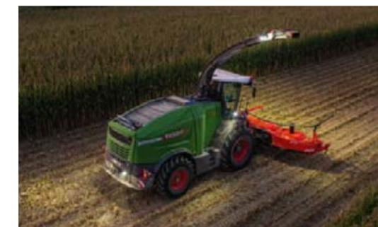
Durchdachte Positionierung der LED-Scheinwerfer um die Maschine erleichtern die Arbeit in der Dämmerung oder bei Dunkelheit und sparen Energie.
