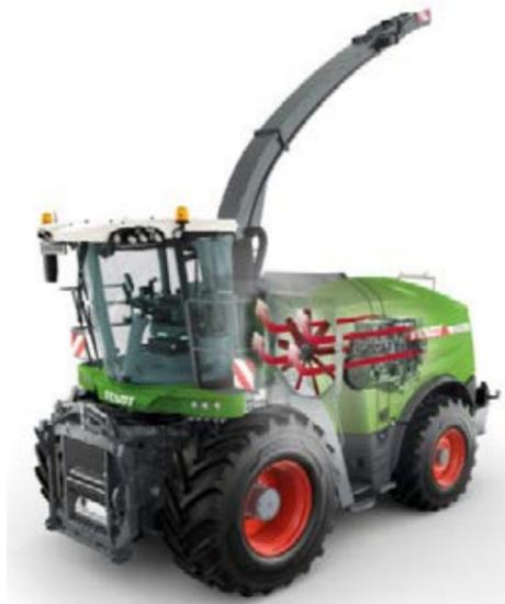
Mit dem auf Wunsch verfügbaren variablen Lüfter wird nur so viel Luft angezogen wie nötig. So werden je nach Einsatz und Kraftbedarf Leistungsreserven freigesetzt oder auch eingespart, was die Gesamteffizienz des Fendt Katana deutlich erhöht. Dank der Umkehrfunktion des Lüfters wird der Schmutz in einstellbaren Zeitabständen durch eine Änderung des Luftstroms weg vom Kühler gedrückt. Somit bringt der Kühler immer volle Kühlleistung und die Reinigungsintervalle verlängern sich.
