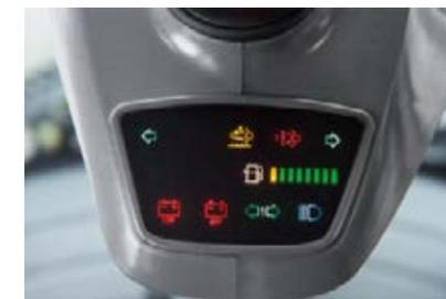
Die zentralen Kontrollleuchten an der Lenksäule geben Auskunft über die wichtigsten Fahrparameter.
