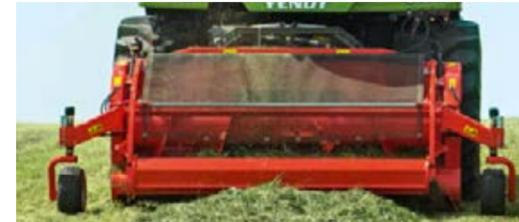
Die Pickup P3003 Maximum mit HD-Antrieb erreicht auch unter extremen Erntebedingungen einen hohen Durchsatz. Die mittig integrierte Tastrolle sorgt für eine noch bessere Boden Anpassung.
