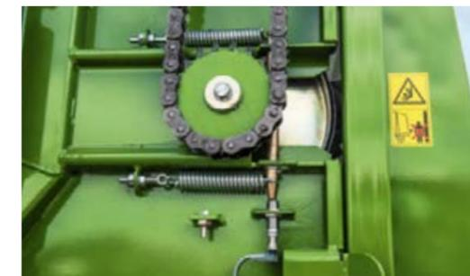
Beim Erreichen des Futterdrucks an der unteren Dosierwalze, stoppen die Bewegungssensoren automatisch den Kratzbodenvorschub.
