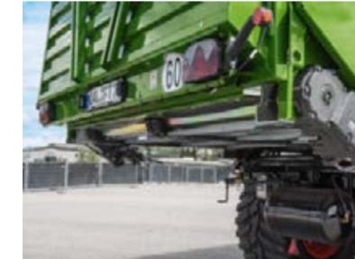
Der feuerverzinkte, abgesenkte Stahlboden bietet optimalen Korrosionsschutz vor allem beim Transport von Maissilage.
