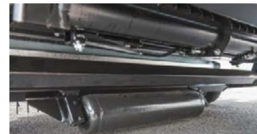
Die mittig hinter der Pick-Up platzierte Tastrolle hält den eingestellten Bodenabstand kontinuierlich ein und gewährleistet auch bei schwierigen Bodenverhältnissen ein sicheres Führen der Pick-Up.
