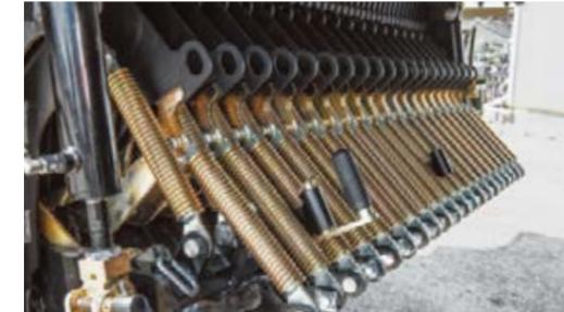
Mit der FlexSharp Messerschleifeinrichtung können die Messer im eingebauten Zustand nachgeschliffen werden.
