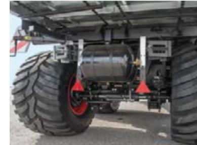
Alle Modelle können optional mit einer hydraulischen oder elektronischen Zwangslenkung ausgestattet werden. Die effiziente und intelligente Deichselkonstruktion ermöglicht auch bei Zwangslenkung einen Einschlagwinkel von 60 Grad.
