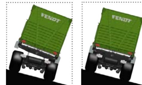
Ohne automatischen Niveaueausgleich neigt sich das Fahrzeug je nach Belastungszustand und Kurvengeschwindigkeit hangabwärts bzw. zur Seite (Abb. links). Mit automatischem Niveaueausgleich durch FSC steht das Fahrzeug immer parallel zum Hang. Unabhängig vom Beladungszustand regelt sich das Fahrzeug immer auf die optimale Fahrwerkshöhe (Abb. rechts).
