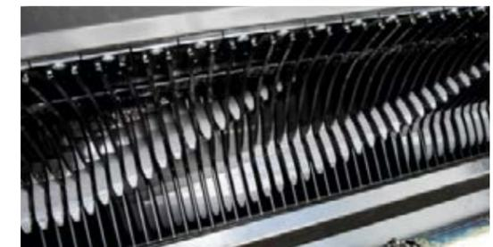
Der Rotor mit 800 mm Durchmesser und sieben spiralförmigen Zinkenreihen aus Hardox-Stahl, ist auf beiden Seiten mit groß dimensionierten Pendelrollenlagern ausgerüstet.
