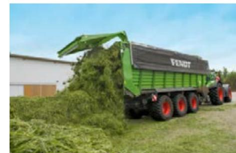
Wahlweise sind alle Wagen der Tigo PR und XR Serie mit 2 oder 3 Dosierwalzen erhältlich. Für mehr Ladevolumen lassen sich die einzelnen Walzen einfach nach hinten ausbauen.
