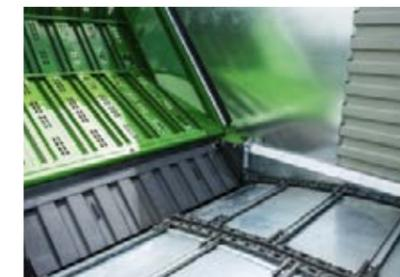
Zum Schutz des Rotors vor Korrosionen und Verschmutzung im Maisernteinsatz hat der Fendt Tigo eine Maiskanalabdeckung, die sich schnell und werkzeuglos einbauen lässt.
