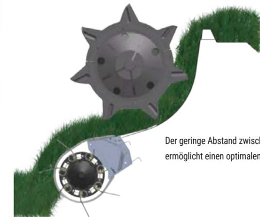
Der geringe Abstand zwischen Pick-Up und Rotor ermöglicht einen optimalen Gutfluss.
