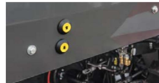
Bequem und einfach lassen sich Schneidwerk und Kratzboden direkt am Ladewagen bedienen.
