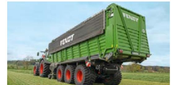
Die hydraulische Laderaumabdeckung ist ganz einfach über das Terminal zu bedienen.
