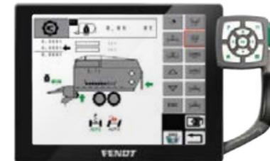
Steuern Sie die Stirnwand und das Schneidwerk direkt über Ihr Terminal. Auch die Pick-Up und die Knickdeichsel lassen sich bequem von hier einstellen.
