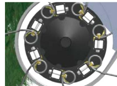
Die synchronisierte Umfangsgeschwindigkeit erlaubt es der Pick-Up mit niedriger, schonender Drehzahl die Entfernung zum Rotor zu überbrücken.
