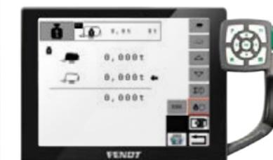
Das bei den hydropneumatischen Fahrwerken optional integrierte Wiegesystem zeigt Ihnen den Ernteertrag bequem in Ihrer Kabine an. Somit behalten Sie die ständige Kontrolle über das Gewicht und die Zuladung.
