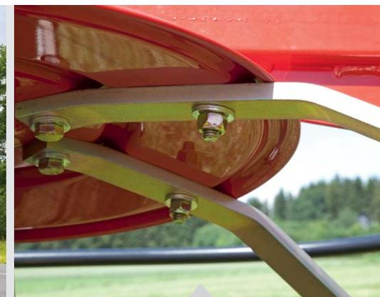
Une surface de contact large pour une transmission idéale de la puissance
