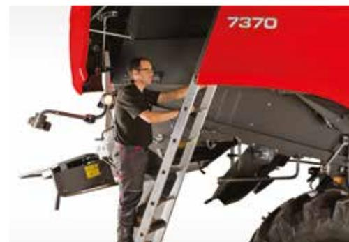
Accès sécurisé au compartiment moteur et à la trémie avec une échelle amovible
