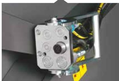
Un multicoupleur combinant les fonctions hydrauliques et électriques est installé de série pour atteler ou dételer rapidement la table lors des changements de parcelle ou pour le transport sur la route.
