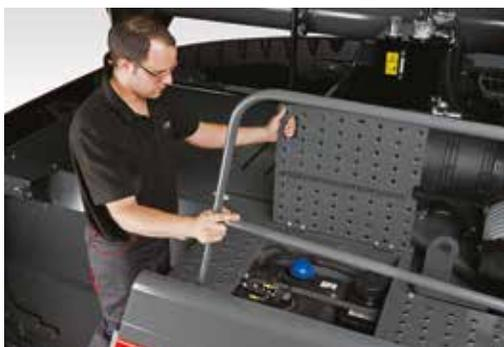
Plein de carburant et d'AdBlue facilité : les deux réservoirs sont situés l'un à côté de l'autre pour un accès rapide
