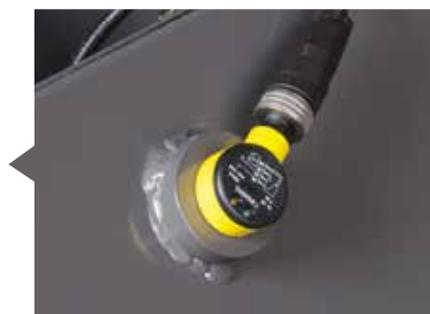
Un capteur d'ôtons affiche sur le terminal en cabine, le volume renvoyé pour vous permettre d'effectuer rapidement des modifications et ainsi améliorer la qualité du grain battu.
