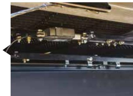
Les grilles électriques sont actionnées à partir de la cabine pour une surveillance facilitée de la qualité du grain tandis que des divisions hautes sur la table de préparation et la grille supérieure maintiennent la récolte répartie régulièrement sur la largeur du caisson sur des terrains irréguliers.
