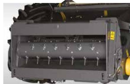
Le rouleau d'alimentation Power Feed Roller, situé à l'avant du convoyeur, permet d'obtenir un débit régulier de la récolte de la table vers le convoyeur. Il est inversé en même temps que la table de coupe et le convoyeur de manière efficace et en toute simplicité depuis la cabine.
