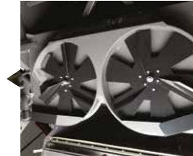
Un éparpilleur de menues pailles à double rotor et à multiples réglages est également disponible pour une répartition homogène au sol.
