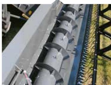
Les doigts de la vis d'alimentation d'un diamètre de 610 mm, disposés sur la largeur totale de la table FreeFlow améliorent le transfert de la récolte pour garantir une alimentation constante et rapide du convoyeur.
