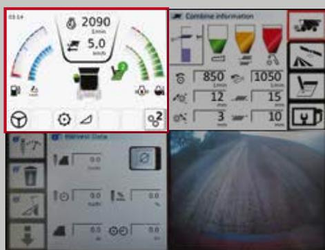
L'écran **Informations générales** s'affiche en permanence en haut à gauche du terminal. Il indique le régime moteur et la vitesse d'avancement. Les niveaux de carburant, d'AdBlue (DEF), d'huile et de température du moteur se trouvent juste à côté. L'affichage renseigne également sur le statut actuel de la moissonneuse-batteuse : niveau de remplissage de la trémie, position des capots de trémie, position de la goulotte et état de la vidange.
