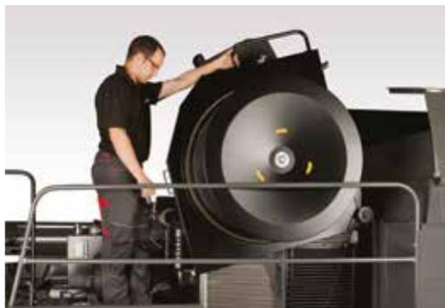
Accès simple et sécurisé pour le nettoyage du radiateur
