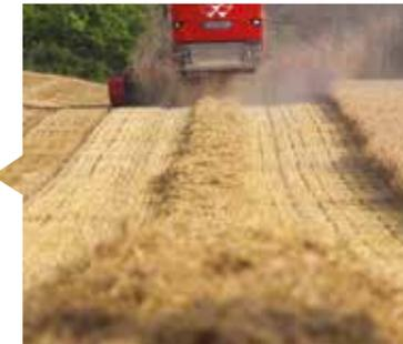
Pour ceux qui récupèrent la paille, le battage est réalisé en douceur et laisse la paille en parfait état pour le pressage et la création de litière et les mélanges pour les animaux. Le réglage électrique des déflecteurs du broyeur de paille est disponible en option. Il permet de diriger la paille broyée à l'écart de la récolte non coupée si nécessaire ou en fonction de l'intensité et de la direction du vent.
