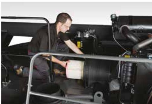
Vérification et nettoyage du filtre à air
