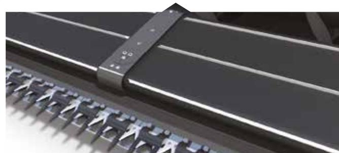
Le lamier est situé à 0.90 m du tube de la vis d'alimentation. La visibilité et les performances sont ainsi optimisées. Les robustes tapis PowerFlow acheminent la récolte depuis le lamier jusqu'au convoyeur à une vitesse constante et se chargent également d'éjecter les pierres afin d'éviter tout endommagement de la machine.
