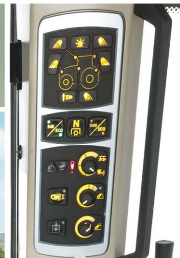
Sélection électrique du régime de prise de force sur le montant pour un meilleur confort de l'utilisateur.
