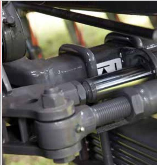
Dispositif de blocage hydraulique de l'essieu arrière.
