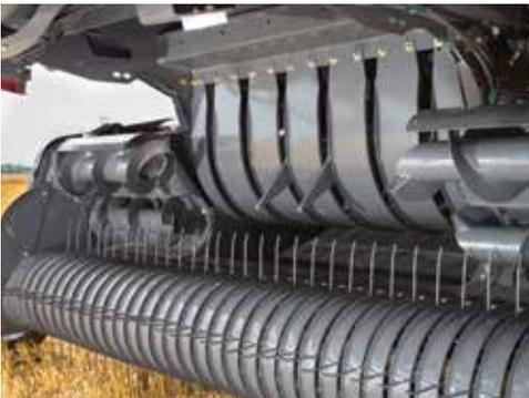
Quatre vis de convergence garantissent une alimentation haute capacité sur les presses en version empaqueteur.
