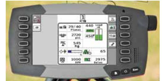
Contrôle automatique de la densité via le moniteur C1000.
