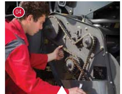
04 Contrôle de la tension des chaînes du ramasseur.
