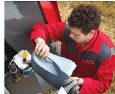
Remplissage de la lubrification automatique des chaînes.
