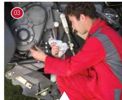
03 Contrôle du niveau d'huile du boîtier principal du dispositif de coupe.
