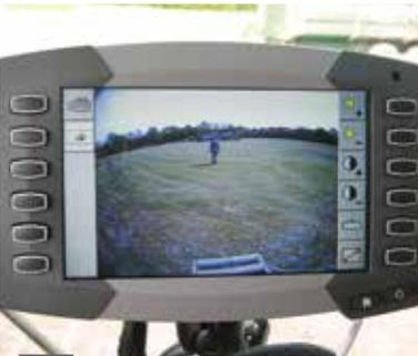
Une caméra vidéo peut être facilement ajoutée à la presse pré-câblée. La presse est dotée de série d'un moniteur couleur C1000 compatible avec le format vidéo.
