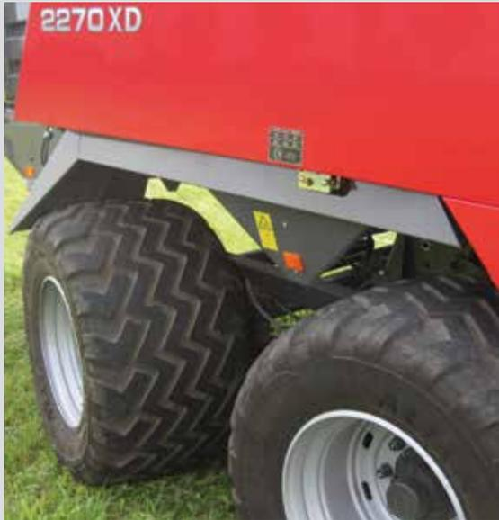
Pneus flotation 620/40R 22,5 à structure radiale, en option.
