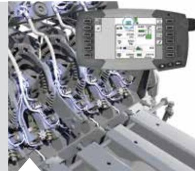
Système de lubrification automatique pour un entretien minimal et un noueur parfaitement fiable.
