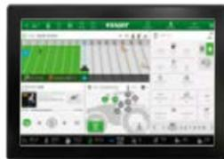
Le terminal supplémentaire de 12" dans le toit du côté droit est relié à tous les autres terminaux. Vous pouvez déplacer le contenu pour que l'affichage corresponde à vos exigences sur le plan ergonomique. Il est également possible d'escamoter partiellement ce terminal dans le toit pour augmenter la visibilité sur route par exemple ; vous pouvez ainsi continuer à utiliser 50 % de l'écran pour afficher les paramètres principaux sur 3 sections.
