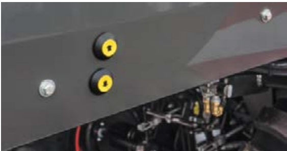
La rampe de couteaux et le fond mouvant se commandent très facilement, directement depuis la machine.
