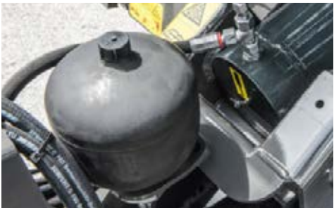
La suspension du timon de la Fendt Tigo améliore encore le confort de conduite.
