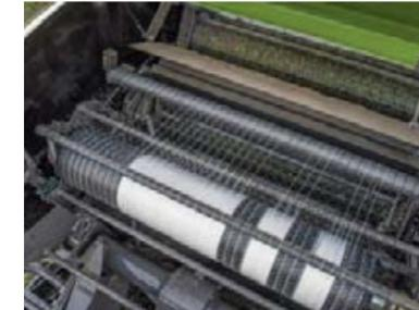
Les balles sont également parfaitement liées autour des bords grâce au dispositif de déploiement du filet. Ce dispositif réduit les pertes au minimum et facilite le stockage des balles.
