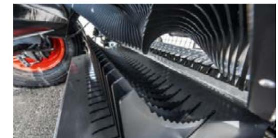
Le modèle haut de gamme 130 F Xtra se distingue quant à lui par un système de coupe hydraulique à 0, 12, 13 et 25 couteaux.
