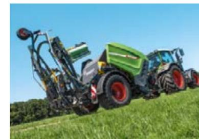
La Fendt Rotana FC est équipée de pneus 620/55 R 26.5 pour un suivi au sol optimal et une conduite routière sûre.
