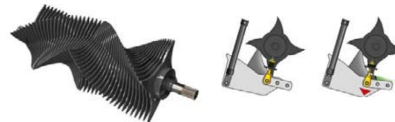
HydroflexControl évite les blocages. En cas de blocage, la partie arrière du fond de canal peut être abaissée de 500 mm.
