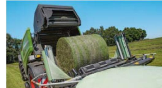
L'entraînement soigneux de l'anneau d'enrubannage par les rouleaux en caoutchouc à entraînement hydraulique atteint rapidement la vitesse nécessaire à un processus d'enrubannage régulier.
