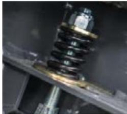
Les ressorts Flex absorbent les pics de charge à l'avant du fond de rotor, empêchant ainsi tout bourrage.
