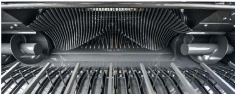
Grâce à la distance réduite entre le pick-up et le rotor, le fourrage est acheminé en souplesse et en toute sécurité. Grâce à sa forme en V, la chambre de pressage se remplit de façon homogène ce qui se traduit par des balles de qualité.
