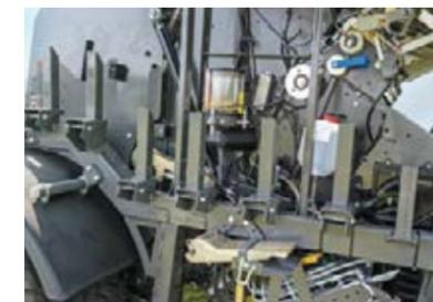
Une longue autonomie avec les 12 supports de rouleau de film. Placez simplement les rouleaux avec l'emballage sur les supports repliables.
