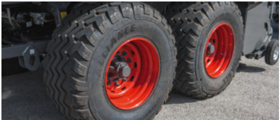
■ Grâce au nouveau châssis, la Fendt Squadra 1290 UD est disponible en diverses largeurs extérieures et différentes tailles de pneus : 620/50R22.5 ou 620/55R26.5 pour une largeur extérieure de moins de trois mètres, et une taille de pneus maximale de 710/50R26.5 pour une largeur extérieure de 3,20 m.
