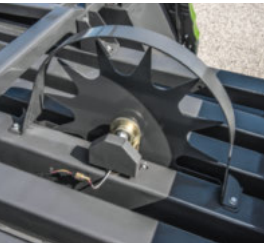
■ Fonction simple de réglage électronique de la longueur des balles
