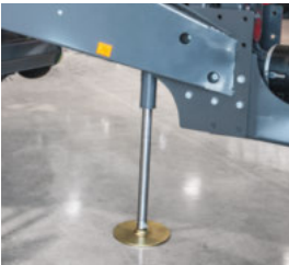
□ La béquille hydraulique en option permet un attelage au tracteur et un dételage faciles et rapides.
