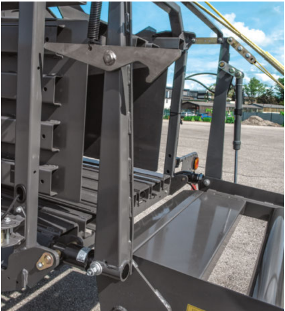
■ Les cellules de charge des balles entre le canal de compression et l'expulseur de balles mesurent le poids exact de la balle, en transférant en même temps les données vers votre terminal. Le système de câblage étant intégré au châssis, les câbles sont donc protégés de tout arrachement.
