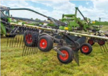
Lors de la descente en bout de champ, ce sont les roues arrière qui entrent en premier en contact avec le sol, puis celles avant. Lors du levage, les toupies sont soulevées à l'avant en premier. Cet effet Jet protège le tapis végétal.
