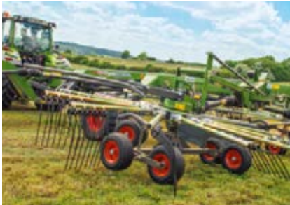
Lors de la descente en bout de champ, ce sont les roues arrière qui entrent en premier en contact avec le sol, puis celles avant. Lors du levage, les toupies sont soulevées à l'avant en premier. Cet effet Jet protège le tapis végétal.
