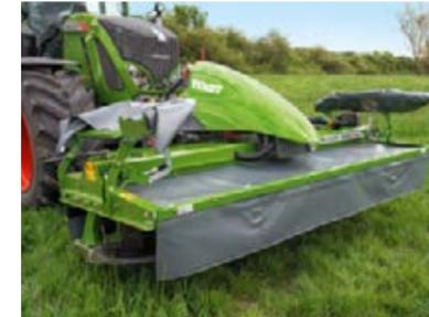
Grâce à un grand angle d'oscillation, les Fendt Slicer suivent les contours du sol à la perfection.
