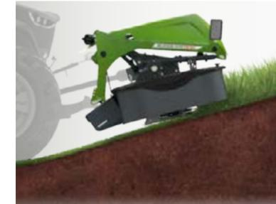
Suspension trainée à timon, bielles de commande, vérins d'attelage hydrauliques avec barres d'accouplement et adaptation optimale au profil transversal et longitudinal du sol. Même sur les terrains les plus vallonnés, la cinématique 3D permet d'obtenir une coupe d'une netteté absolue.
