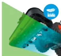
La suspension hydropneumatique à l'aide du système TurboLift est de série sur la Slicer FQ. Le réglage progressif s'effectue sans aucun outil. De ce fait, la pression au sol est toujours adaptée à la perfection aux conditions.
