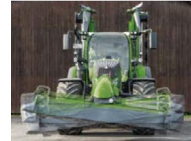
La Fendt Slicer 310 FPK est très proche du tracteur et extrêmement maniable grâce à un système pendulaire spécial.
