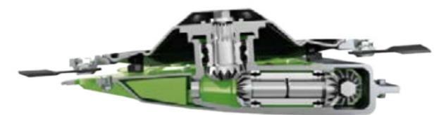
L'entraînement à renvois d'angle compacts assure une importante sortie de puissance à tous les disques de faucheuse et donc une coupe nette avec une faible demande de puissance.
