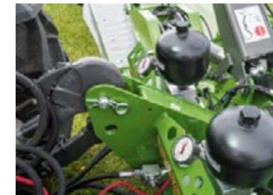
Ayez toujours la maîtrise de la pression de contact du système TurboLift grâce à l'indicateur de pression sur le champ et adaptez-la aisément depuis le confort de votre cabine.
