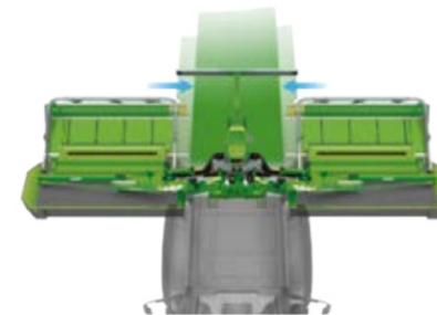
Le système de protection anti-collision breveté SafetySwing peut faire osciller vers le haut et vers l'arrière la combinaison de faucheuses jusqu'à 1,5 m si nécessaire.
