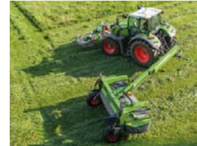
Le lamier des Fendt Slicer TKC et TRC est soulevé par les points extérieurs du robuste cadre de support, pour garantir un suivi parfait des contours de terrain.
