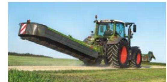
La faucheuse oscille sur 90° à l'arrière de la cabine en position de transport.
