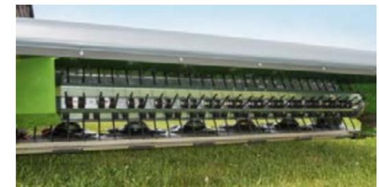
Le conditionneur à rouleaux RC garantit un conditionnement en douceur sans perte de feuillage. Les éléments en caoutchouc peuvent être remplacés individuellement en cas d'usure ou de détérioration.
