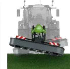
Liberté de mouvement avec un L majuscule : grâce à un angle d'oscillation transversale de +/-13° et un jeu vertical de près de 650 mm, la faucheuse frontale Slicer FQ offre ce qu'il y a de mieux en matière de flexibilité.
