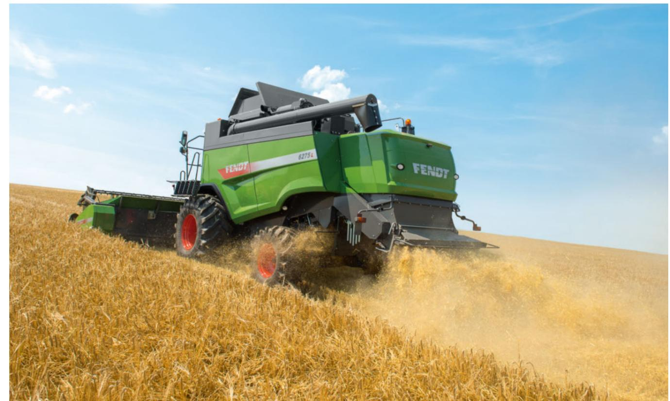
L'utilisateur peut passer facilement et rapidement du mode dépôt d'andains au mode broyage et vice-versa : il suffit simplement de déplacer un levier pour pivoter la tôle de fond de hotte.
