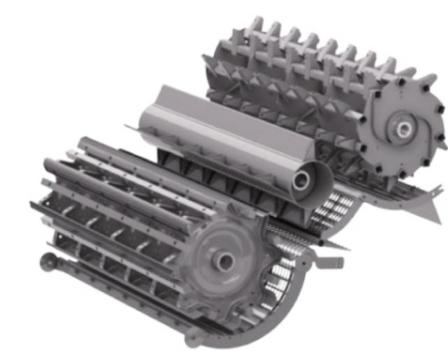
Le contre-séparateur est entièrement au-dessus du séparateur Multi-Crop. Cette position est principalement recommandée pour les récoltes dont le battage est aisé et dans des conditions sèches.
