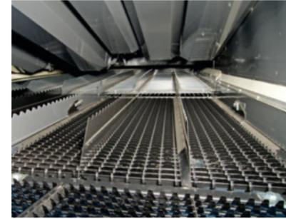
Un capteur enregistre le volume des òtons et l'affiche sur le terminal Vario 7". La machine s'adapte rapidement, pour obtenir la meilleure qualité de grain possible.
