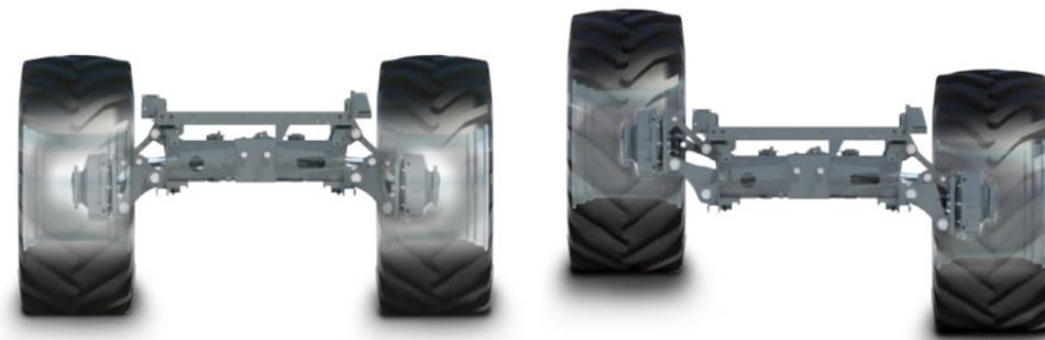
Facilité de basculement entre les modes travail et transport à l'aide du système ParaLevel, qui compense les dévers jusqu'à 20%.
